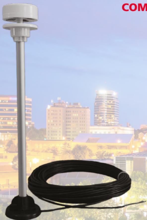
Ce CV7 avec Compas/GPS est une solution pour les applications mobiles. L'alignement ne pose plus de problème ! Il est alimenté en 8-30 VDC et le signal data sort en RS232/RS422/ 5 V / NMEA0183.
