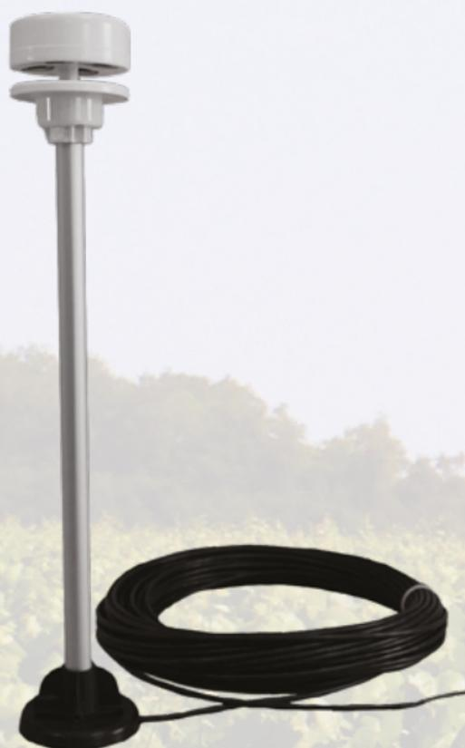
Cette girouette-anémomètre à ultrasons se raccorde directement à une entrée impulsions et potentiomètre (type Davis par exemple). Ce capteur est facile à intégrer à une station météo autonome dès l'installation initiale ou en remplacement d'un capteur mécanique. .
