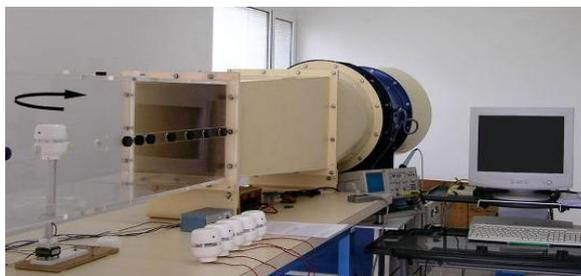
Le CV7 est placé dans la soufflerie sur un support rotatif évoluant par pas de 9 degrés sous contrôle d'un ordinateur programmé à cet effet. Le capteur est orienté dans l'axe de vent 0 degré, puis 40 mesures de module et d'angle sont enregistrées.
