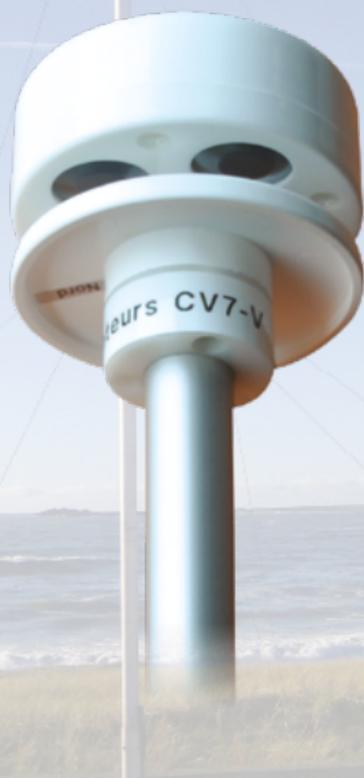
Voici la version analogique du CV7. La sortie 0-10 V permet une intégration directe à des systèmes existants qui réclament un signal analogique.
